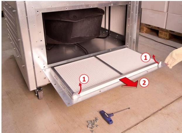
Abb. 16 Feinstaubfilter entnehmen
