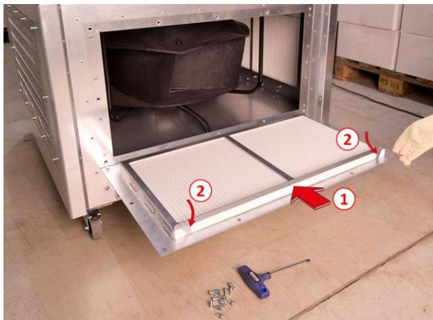
Abb. 17 Feinstaubfilter einsetzen
