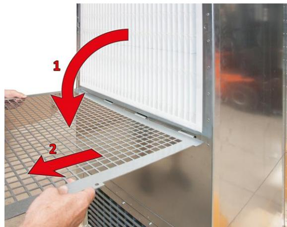
Abb. 8 Filterabdeckung entfernen
