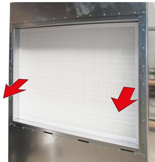
Abb. 11 Hauptfilter entnehmen
